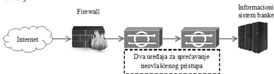
Slika 5. Prikaz filtriranja saobraćaja pomoću dva serijski povezanih IPS uređaja
